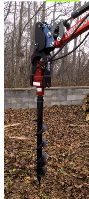
Punta con terminale per terreno normale Auger With Pilot Bit for normal soil
